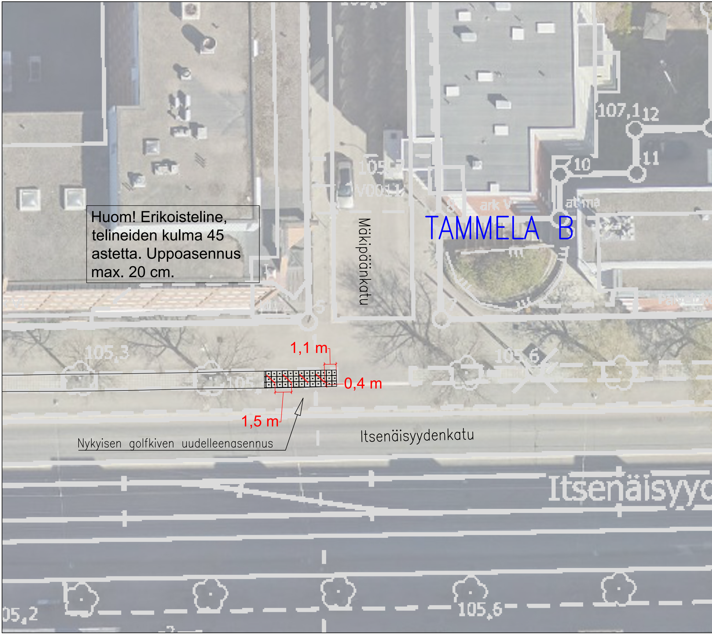
PERIAATEKUVA UPPOASENNUKSESTA (MITAT RIIPPUU VALMISTAJASTA)
